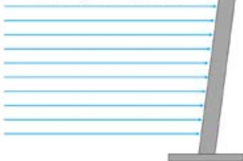
Pressão da água em muro com dreno
